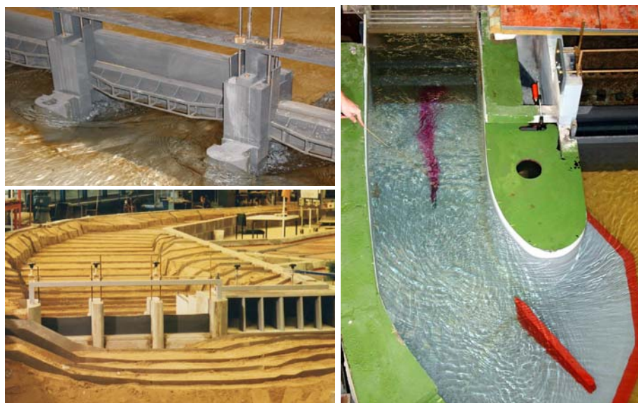
Oben: Modell einer Schützenanlage, Unten: Modell im Aufbau, Rechts: Modell Kraftwerksanströmung.
